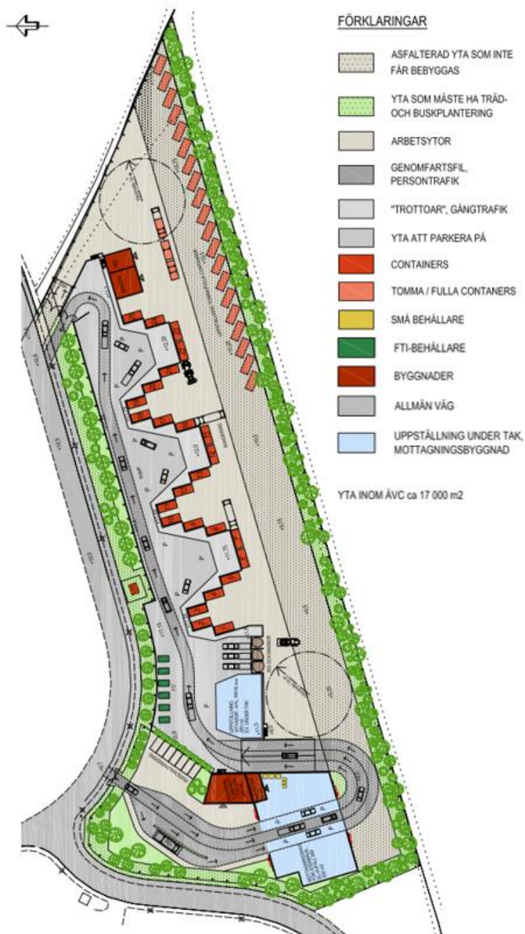
Figur 3. Utformningsförslag med vinklad enkelsidig ramp
