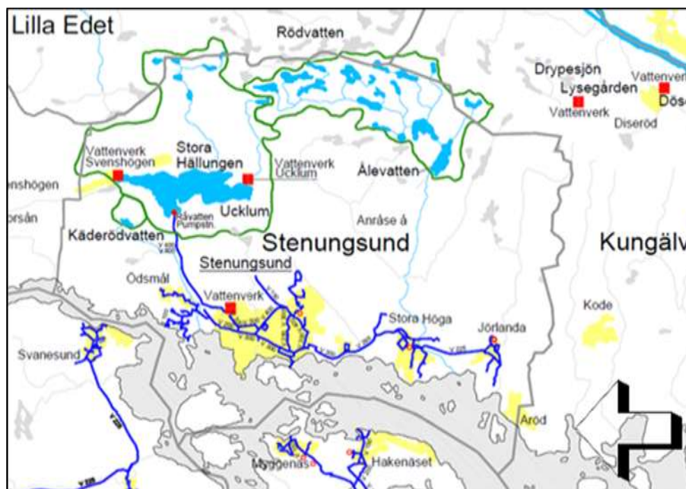
Figur 3. Översikt huvudledningar för vattenförsörjning i Stenungsund
